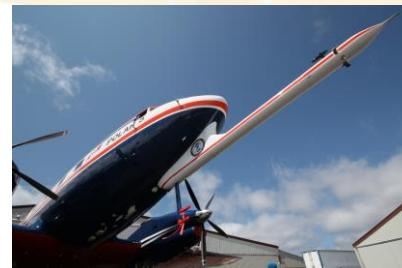
messWERK entwickelt auch Kundenspezifische Sensorsysteme, wie z. B. eine Turbulenzmesssonde für Polarflugzeuge des AWI. Neben der Entwicklung gehören auch Bau, Zulassungsversuche, Systemintegration und Inflight-Kalibrierung mit zum angebotenen Spektrum.
