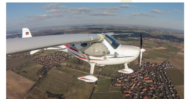
Dieses Forschungsflugzeug wird für interne Sondenentwicklung und -kalibrierung sowie als Messplattform für Forschungsprojekte mit externen Kunden im Bereich der Meteorologie und Flugreglerentwicklung genutzt.
